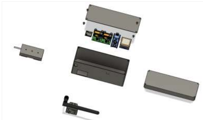
Gambar 4. 3 Desain 3D Perangkat Pendaki
